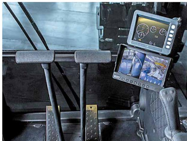
Монитор и камера ViSUM в кабине экскаватора
