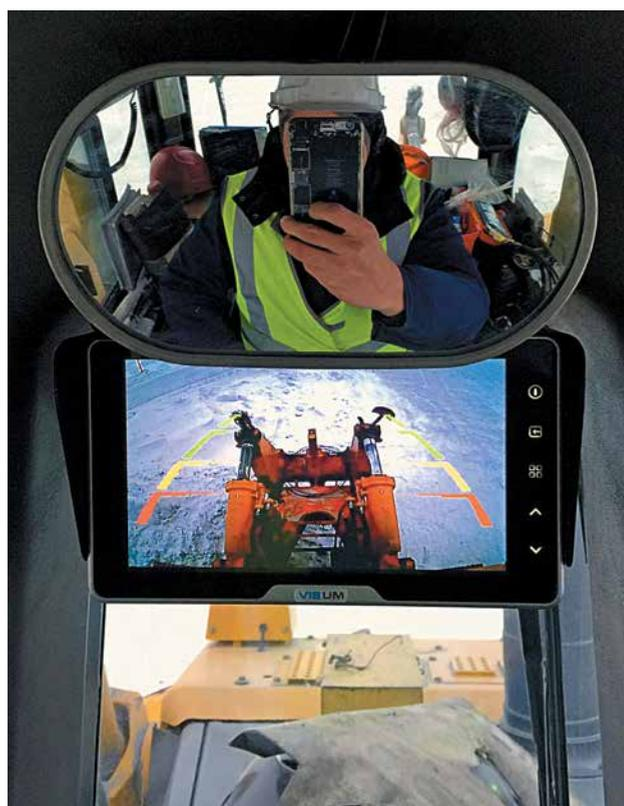
Камера заднего вида и монитор ViSUM в кабине бульдозера
